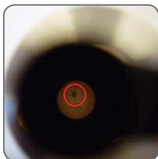
Чёрная частица (например, от окисления, уплотнений и т. д.)
