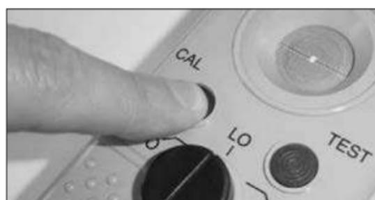
Au cas où vous allez procéder au test d'une huile d'une autre marque, le ré-étalonnage de l'appareil sera nécessaire. (voir paragraphe 3.1)
