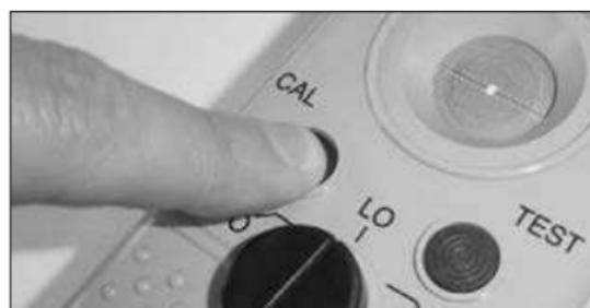
En caso de comprobar un aceite de otra marca, se necesitará la re-calibración del instrumento.
